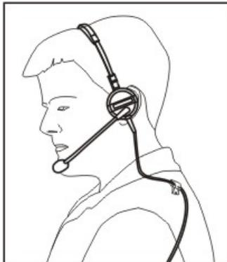
耳机由听筒、麦克风、衣夹、电缆组成。耳机与音频电缆的音频电缆端相连，而音频电缆又与 Thor VM1 相连。将音频连接器与耳机快接电缆端对准。将电缆端紧紧地挤压在一起，直至它们发出喀哒声并锁定到位。
